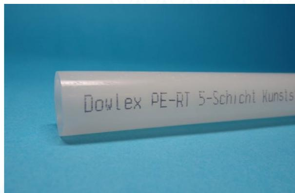
Durch das spezielle Fertigungsverfahren wird aus dem speziell modifizierten Polyethylen (Kurzzeichen PE) mittels eines Extrusionsverfahren das Bavaria-PE-RT-Rohr in einem Arbeitsgang als 5-Schicht-Rohr produziert. Die Evoh-Schicht sorgt für eine sehr gute Sauerstoffbarrierewirkung. Das Kunststoffrohr wird durch die äußere PE-RT-Schicht vor Beschädigungen von außen geschützt.
